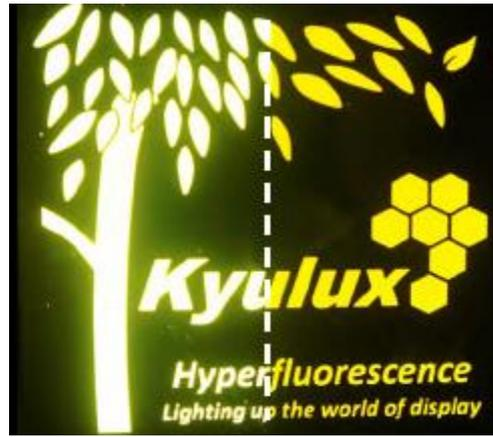
HF 技術を用いた黄色発光有機 EL パネル(左側)
