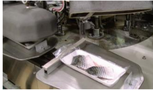
羽田空港内鮮魚加工センター 真空包装により輸出も可能
